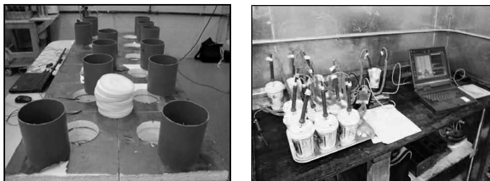
Рис. 1. Калориметрические установки «Coffee cup»
