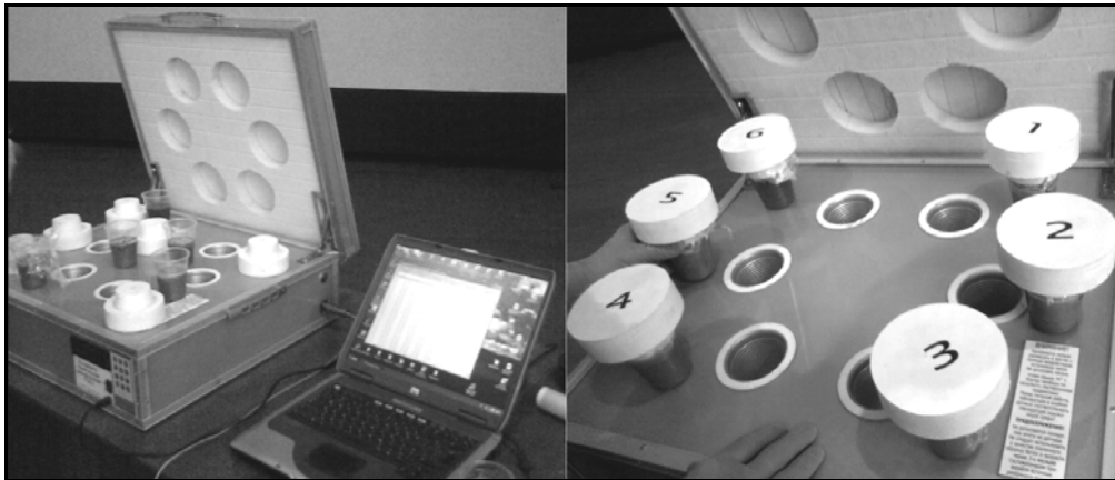
Рис. 5. Термосный calorimetr сравнения «Будиндустрия ЛТД» УСК-2
